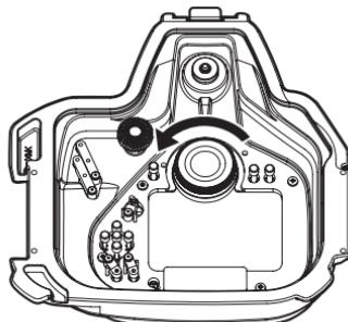
2 交換するピックアップファインダーを時計方向にまわして取り付ける
