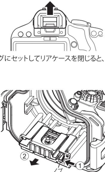
2 カメラトレーの固定ネジを付属の取付工具でまわし、カメラの三脚ネジ穴にしっかりと取り付ける
