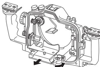
3 クイックシューのAの溝にフォーカスモードセレクトダイヤルを合わせた状態で、付属の取付工具を使ってクイックシューを三脚ネジ穴に固定する
