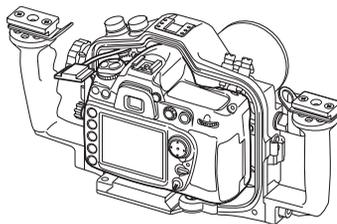
**7 クイックロックをLOCKの位置に合わせてカメラを固定する****8 ハウジングの電源スイッチを回して、カメラの電源スイッチと向きを合わせる****9 シンクロコネクタをカメラのアクセサリシューに差し込む****⚠ 注意**
